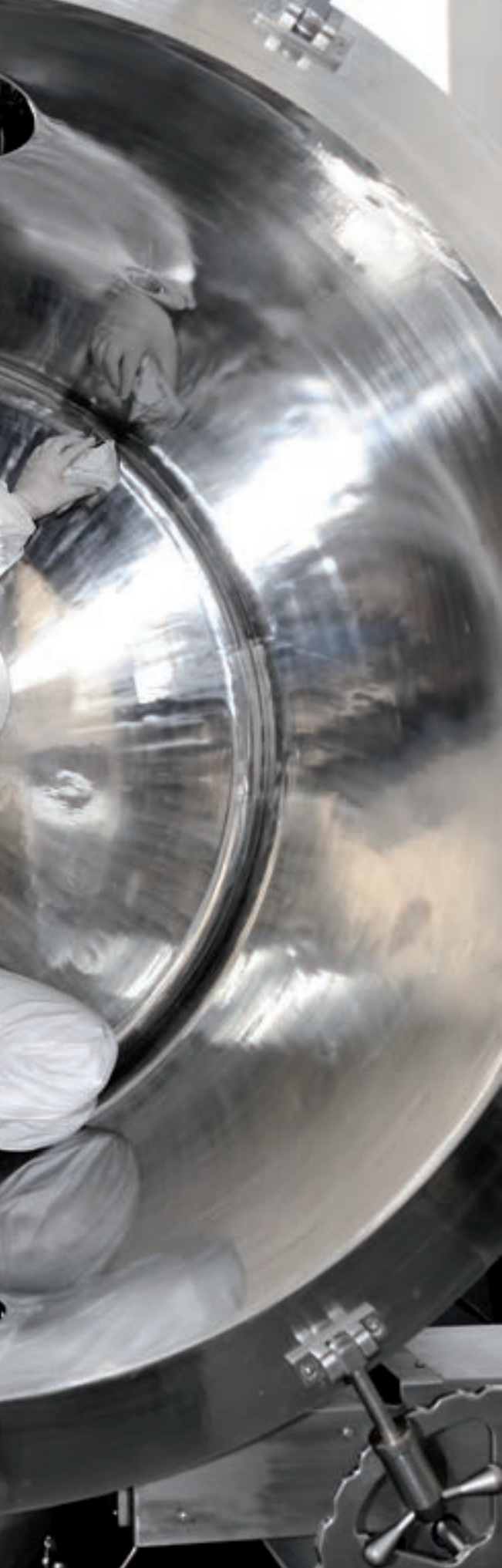
El perfil del agitador permite una continua modificación del producto y favorece el intercambio térmico, reduciendo los tiempos de secado. CosmoDry System - vista frontal.
