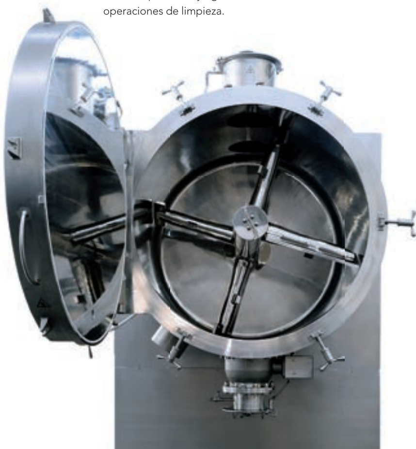
El perfil del agitador permite una continua modificación del producto y favorece el intercambio térmico, reduciendo los tiempos de secado. CosmoDry System - vista frontal.
