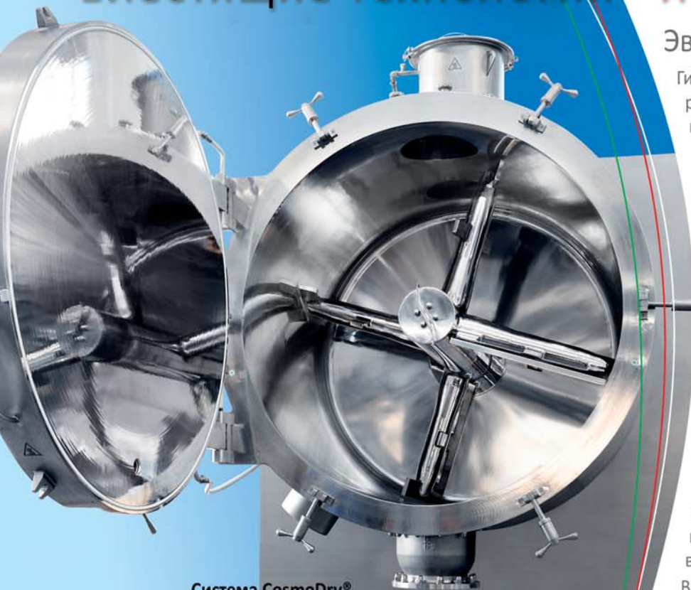
Система CosmoDry®. Горизонтальная лопастная вакуумная сушилка с концентрической мешалкой с разборным валом
