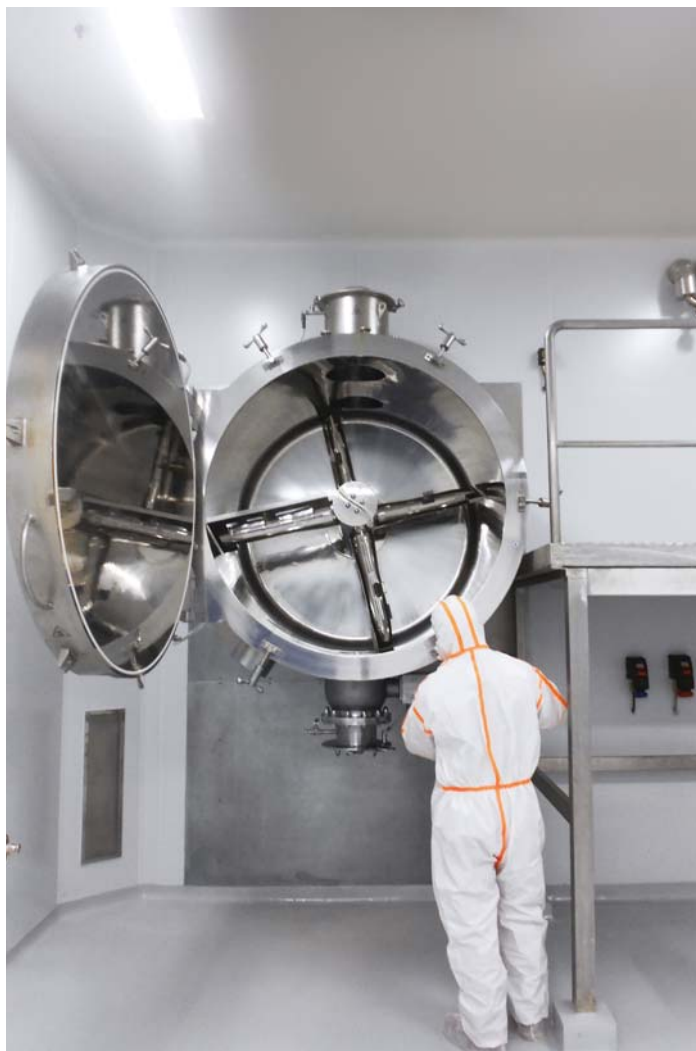
Установка сушилки CosmoDry в чистой комнате
