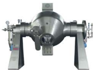
Система CRIOX®. Двухконусная роторная вакуумная сушилка с блоком дробилок для гомогенизации продукта
