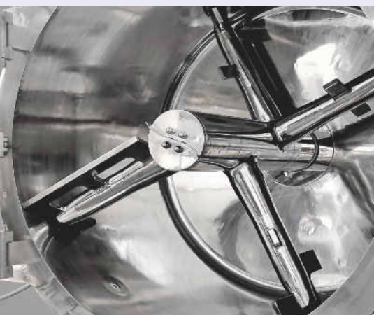
Im Trockner befindet sich ein konzentrischer Rührer mit erwärmter Welle, der in mehrere Teile zerlegbar ist
