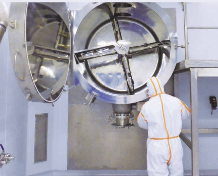
Der horizontale Vakuumschaufeltrockner Cosmodry System eignet sich speziell für die Trocknung von feuchten Massen aus Filterpressen oder Zentrifugen in Chemie und Pharma
