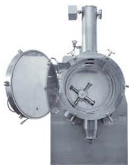
Planex System: Nuevo secador de cuerpo fijo al vacío patentado con agitador excéntrico con dos movimientos independientes.
