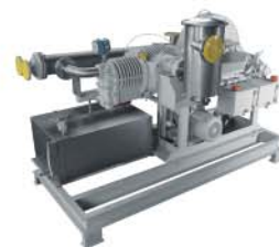
Saurus939: Bomba de vacío LubriZero, de bajo mantenimiento, para el uso en aplicaciones muy exigentes.
